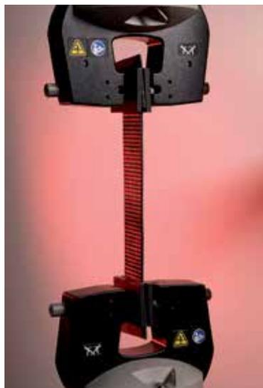
**ПРОЧНОСТЬ НА РАЗРЫВ** - Двухколонный динамометр с 5кН давлением.
