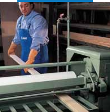
Нанесение валиком Adesivil D3 для склеивания деревянных элементов
